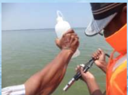
ගැඹුරු මුහුදේ දී ජල හා අවසාදිත සාම්පල එක් රැස් කර ගන්නා අයුරු
