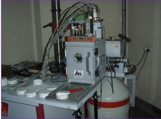
XRF විද්‍යාගාරය තුළ ස්ථාපනය කර ඇති ශක්ති අපකිරණ X-කිරණ ප්‍රතිදීප්ති උපකරණ පද්ධතිය (XRF System)
